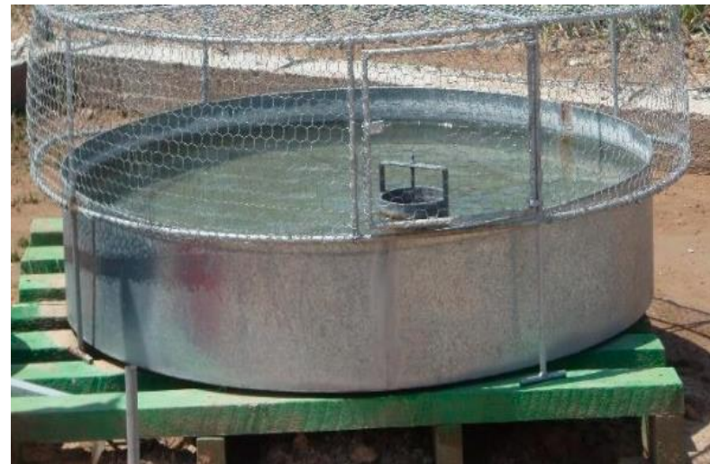
Εξατμισήμετρο (π.χ. ET_c = K_c \times K_r \times ET )
